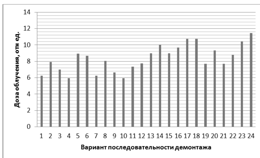
Рис.1. Доза облучения персонала при возможных вариантах последовательности демонтажа четырех радиоактивных объектов в помещении.
